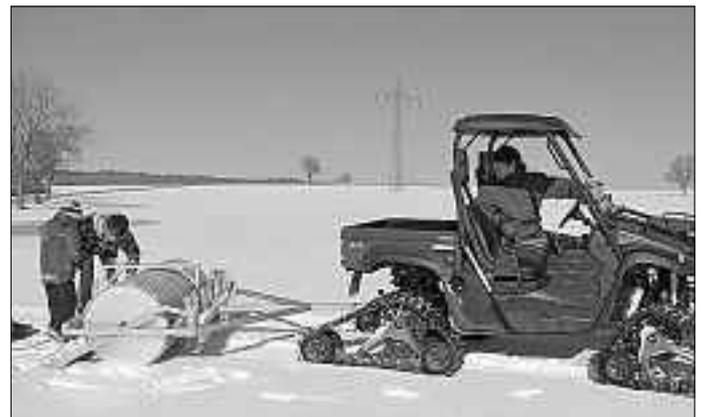
*Mehrzweckfahrzeug mit Schneewalze und Spurplatten.*
