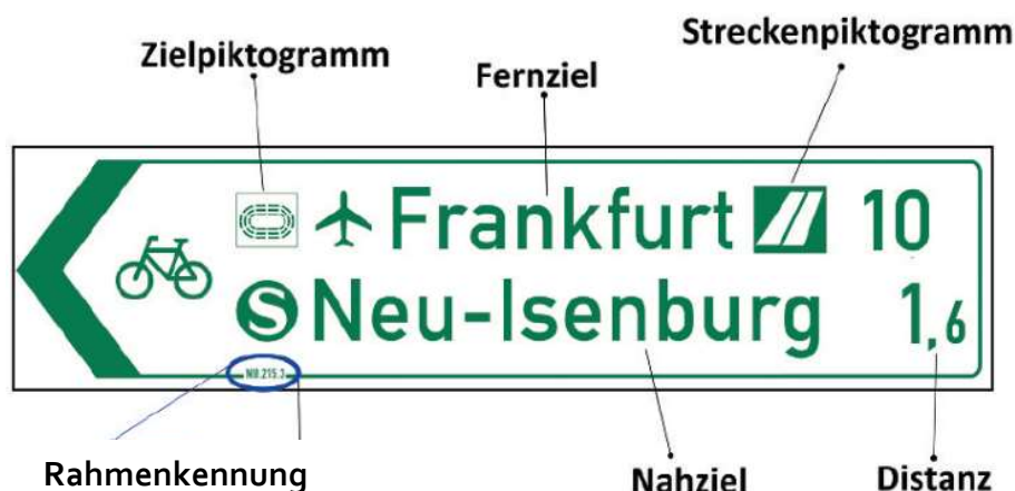
Abbildung 35: Erläuterung der Schilderhalte am Beispiel eines Zielwegweisers (Typ Pfeilwegweiser) (vgl. HMWEVL, 2018)
